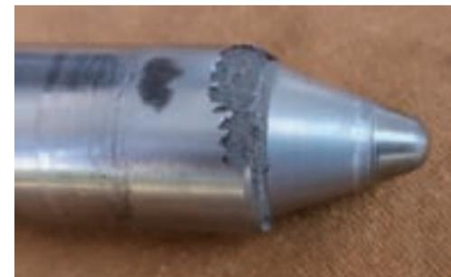
a. 阀芯的阀口被冲蚀
