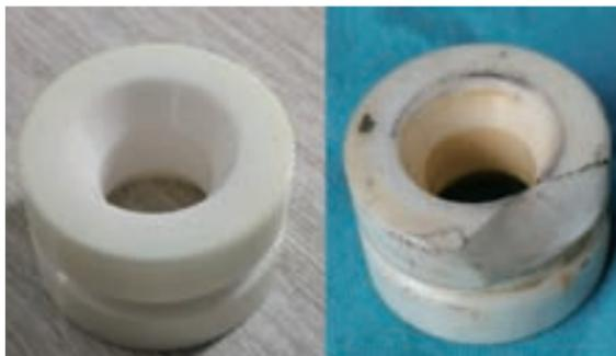
图16 完好阀座与破碎阀座对比
