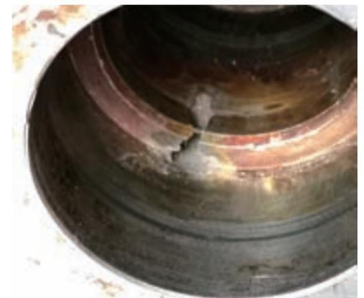
图 12 阀体被冲蚀的状况
