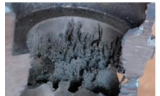
图 13 导套被冲蚀的状况
