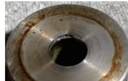
b. 阀座的阀口被冲蚀
