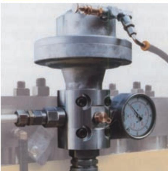
图17 调压阀进气口的流阀
