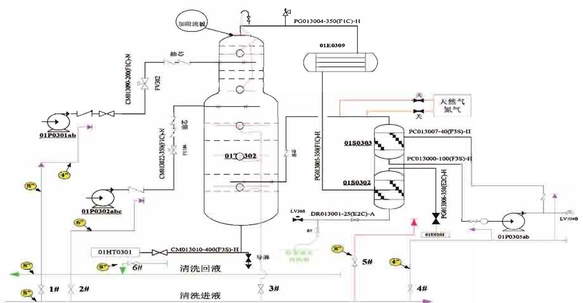
图 1 CO<sub>2</sub>吸收塔系统流程
